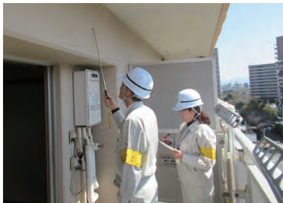
(左) 外壁改修工事の実施状況 (右上) 外壁や屋上防水、設備等の計画改修設計業務を実施 (右下) 外壁の劣化損傷を確認するための打診調査の様子
